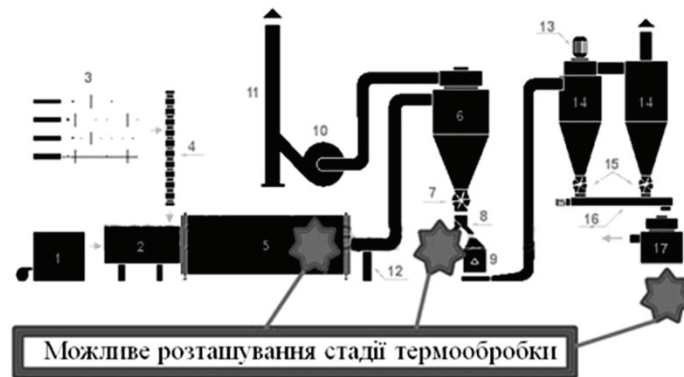
Рис. 5. Можливі місця розташування стадії термообробки на класичній лінії виробництва біопалива: 1 – газовий пальник; 2 – змішувач; 3 – склад сировини; 4 – транспортер; 5 – барабанна сушарка; 6 – великий циклон; 7 – шлюзовий затвор; 8 – розподілювач; 9 – молоткова дробарка; 10 – димосос; 11 – труба димососа; 12 – відбиральник; 13 – вентилятор; 14 – циклони; 15 – дозатори (шлюзові затвори); 16 – шнекова подача; 17 – гранулятор.
