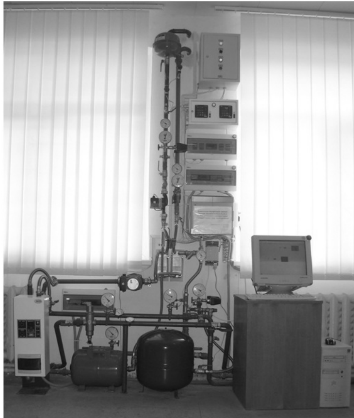
Рис. 2. Оригінальна схема підключення теплового насоса типу «повітря-рідина».
