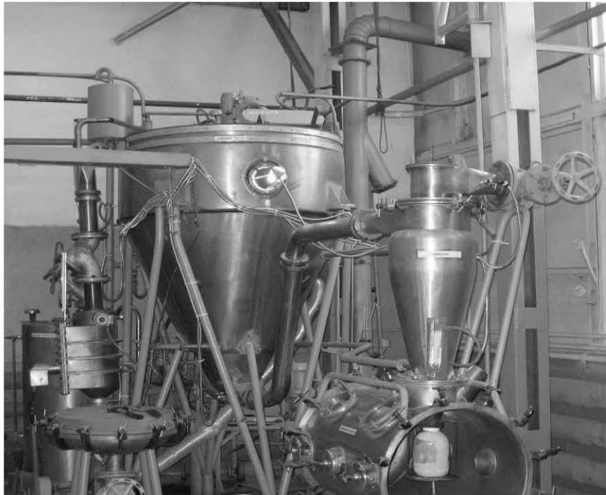
Рис. 1. Загальний вигляд експериментальної розпилювальної сушарки (ІТТФ НАН України).
