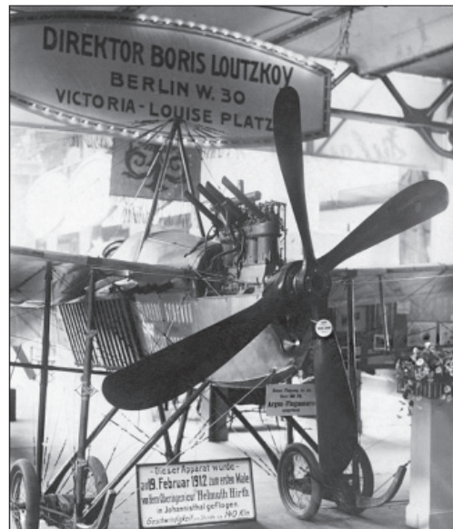
Літак із двома двигунами внутрішнього згоряння і двома співвісно розташованими гвинтами конструкції Б.Г. Луцького (Берлін, 1912)
