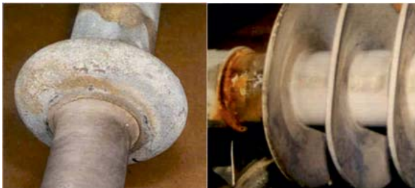
Рис. 12. Пошкодження корозією наконечників стрижня
