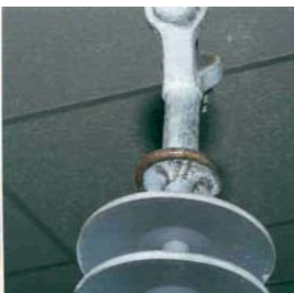
Рис. 7. Пошкодження наконечників внаслідок горіння дуги
