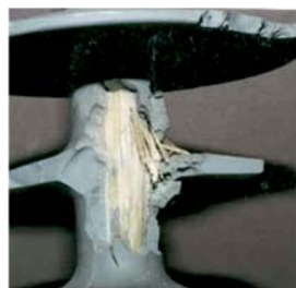
Рис. 10. Пошкодження утримуючого склопластикового стрижня
