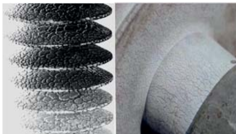
Рис. 13. Тріщини на поверхні ізолятора глибиною більше 0,1 мм
