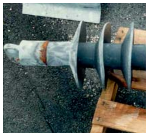
Рис. 7. Пошкодження наконечників внаслідок горіння дуги
