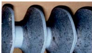
Рис. 4. Ізолятор пошкоджений пліснявою
