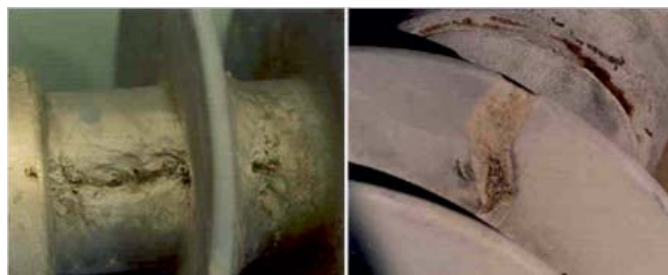
Рис. 15. Поверхнева ерозія полімерного покриття
