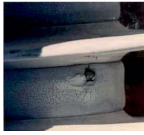
Рис. 11. Пошкодження з оголенням утримуючого склопластикового стрижня
