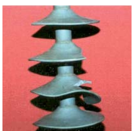
Рис. 6. Ізолятор із незначними механічними пошкодженнями
