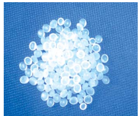
Рис. 4. Гранулы полиэтилена, используемые при изготовлении сшитого-полиэтиленовой изоляции [18].
