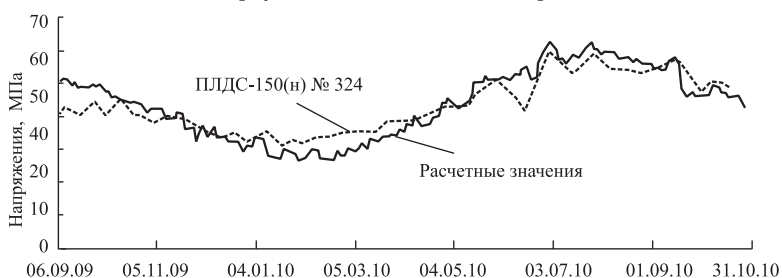
Рис. 9. Кольцевые напряжения в стальной оболочке
