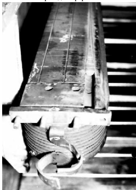
Рис. 3. Выпадение демпферного стержня из паза
