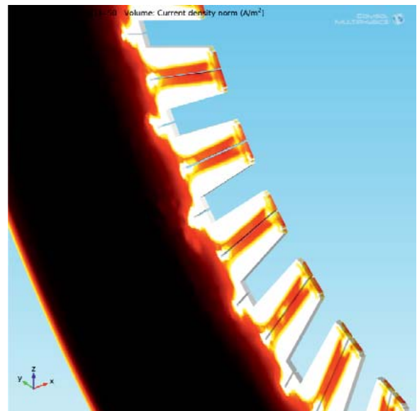
Рис. 6. Распределение плотности тока в листе крайнего пакета сердечника статора
