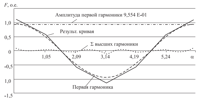
Рис. 2. Распределение по окружности намагничивающей силы F одного слоя обмотки статора турбогенератора ТГВ - 200 с учётом пространственных гармоник ( \alpha - \text{координата по окружности} )
