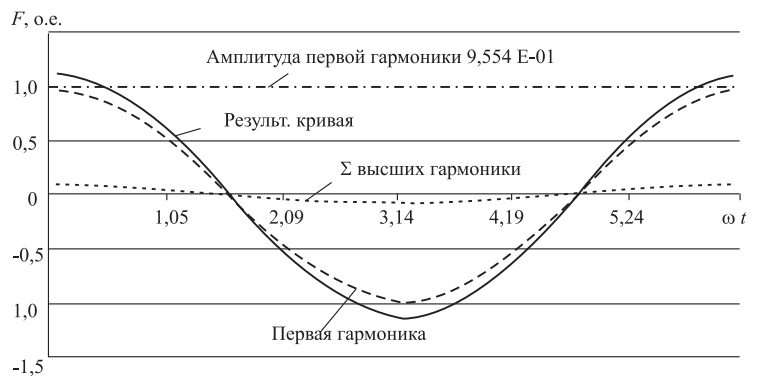
Рис. 1. Распределение по окружности намагничивающей силы F одного слоя обмотки статора турбогенератора ТГВ-200 на оси фазы A с учётом пространственных гармоник на (\omega t - \text{частота})
