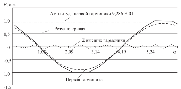
Рис. 3. Распределение по окружности намагничивающей силы F двухслойной обмотки статора турбогенератора ТГВ-200 с учётом пространственных гармоник. Коэффициент укорочения 0,8 ( \alpha - \text{координата по окружности} )
