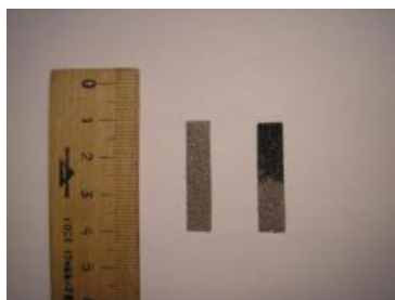
Рис. 1. Фотография электрода из никелевой пены с нанесённым композитом и СЭМ-изображения микроструктуры никелевой пены и никелевой пены, покрытой композитом.
