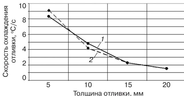
Рис. 2. Теоретический и экспериментальный графики зависимости скорости охлаждения чугуновой отливки в виде пластины с холодильником от толщины стенки: 1 – экспериментальные данные; 2 – теоретические данные
