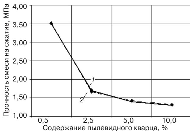
Рис. 1. Теоретический и экспериментальный графики зависимости прочности стержневой смеси на основе фосфата кремния от состава: 1 – экспериментальные данные; 2 – теоретические данные
