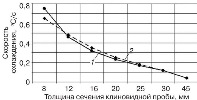
Рис. 3. Теоретический и экспериментальный графики зависимости скорости охлаждения чугуновой отливки в виде клиновидной пробы от толщины: 1 – экспериментальные данные; 2 – теоретические данные
