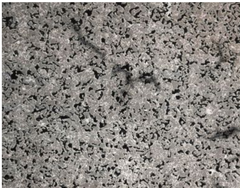
Рис. 2. Изображение образца на глубине \sim 0,3 мм от поверхности: темное – TiC, светлое – прослойки жидкой фазы на основе Ni
