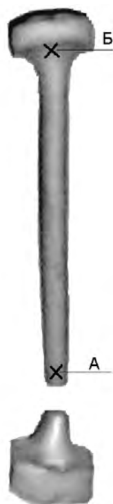
Рис. 1. Внешний вид образца после спекания в условиях одноосного растяжения: крестиками отмечены места фотографирования структуры
