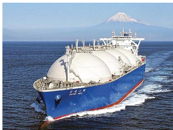
Рис. 1. Внешний вид газовоза со сферическими танками типа «Moss»
