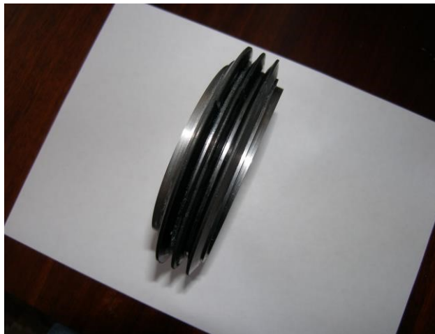
Рис. 1. Общий вид алмазного эластичного червячного хона с профилем архимедова червяка
