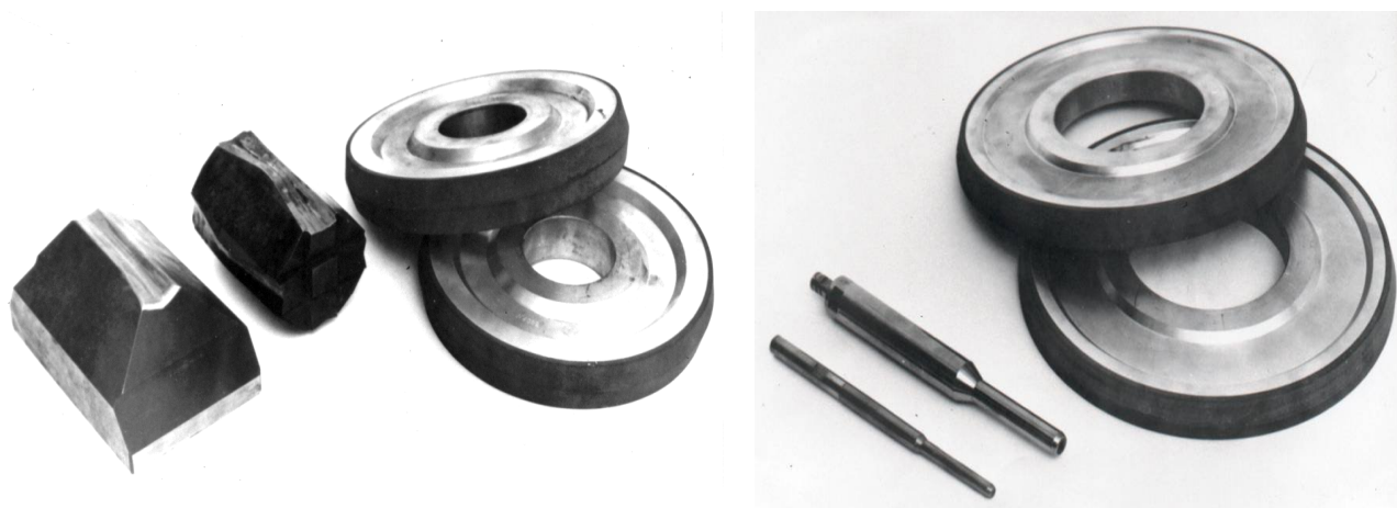
Рис. 3. Загальний вигляд шліфувальних кругів: а – форми 1EE1, б – 1U1
