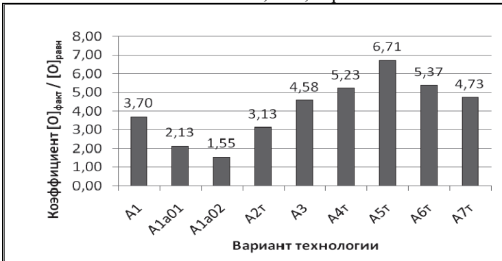
Рис.4. Влияние варианта технологии кислородно-конвертерной плавки на величину отношения [O]_{\text{факт}} / [O]_{\text{равн}} при одинаковом содержании углерода.
