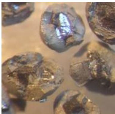
Рис. 2. Фрагменты алмазно-твердосплавных гранул после механических испытаний на сжатие
