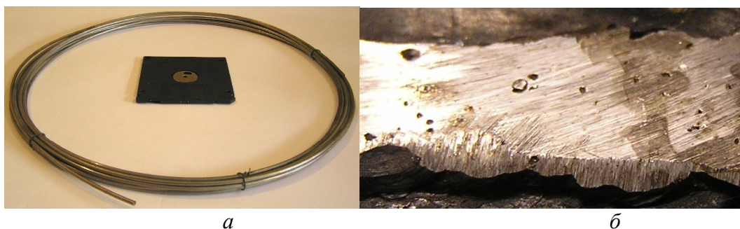
Рис.3. Общий вид опытной порошковой проволоки с алмазными гранулами –(а); и общий вид наплавки из порошковой проволоки на стальной пластине –(б)
