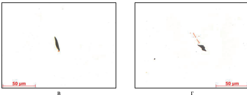
Рис. 5. Неметаллические включения в ступицах исследуемых колёс: а, в – с маркировкой «неуд», б, г – с маркировкой «уд».
