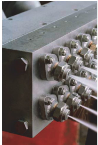
Рис. 1 Коллектор селективной подачи эмульсии.
