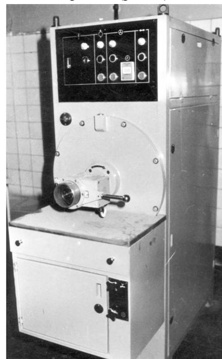
Рис. 4. Общий вид вихревого аппарата, основанного на принципе бегущего магнитного поля, конструкции ИСМ НАН Украины
