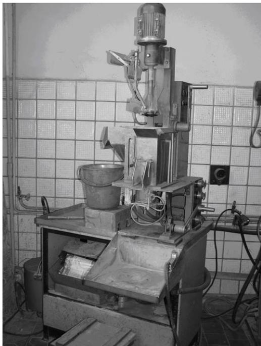
Рис. 8. Общий вид флотомашины с ультразвуковой камерой.
