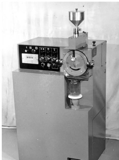
Рис. 3. Общий вид роторной дробилки непрерывного действия конструкции ИСМ НАН Украины
