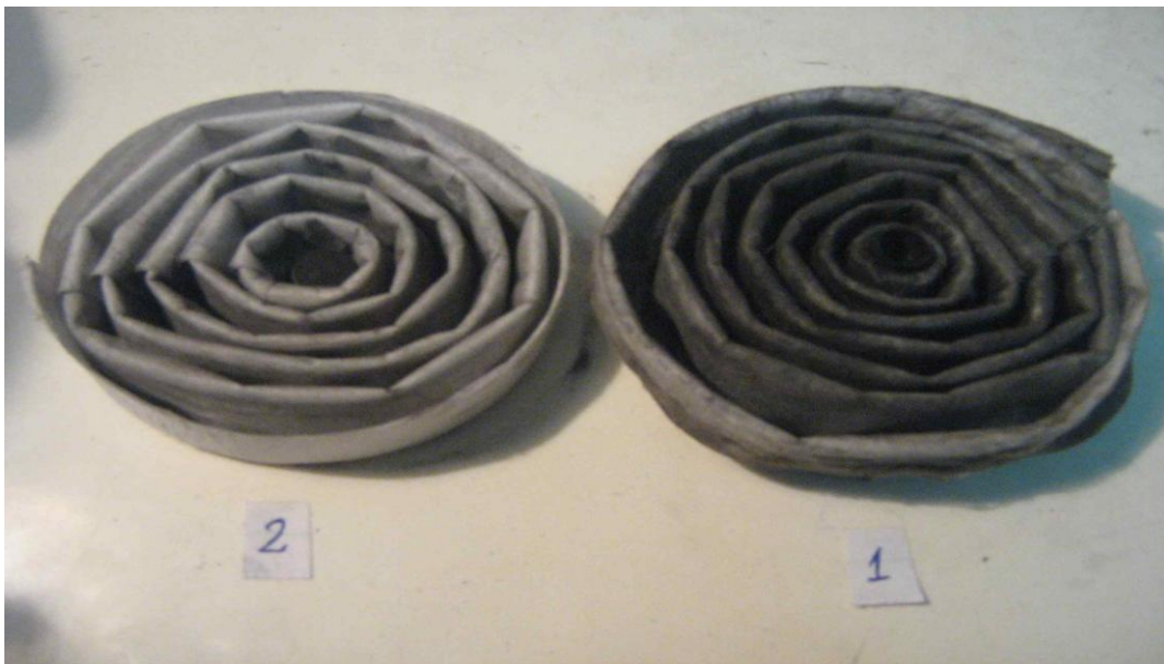
Рисунок 9 – Фільтри після заповнення: передфільтр (1) і основний фільтр (2)
