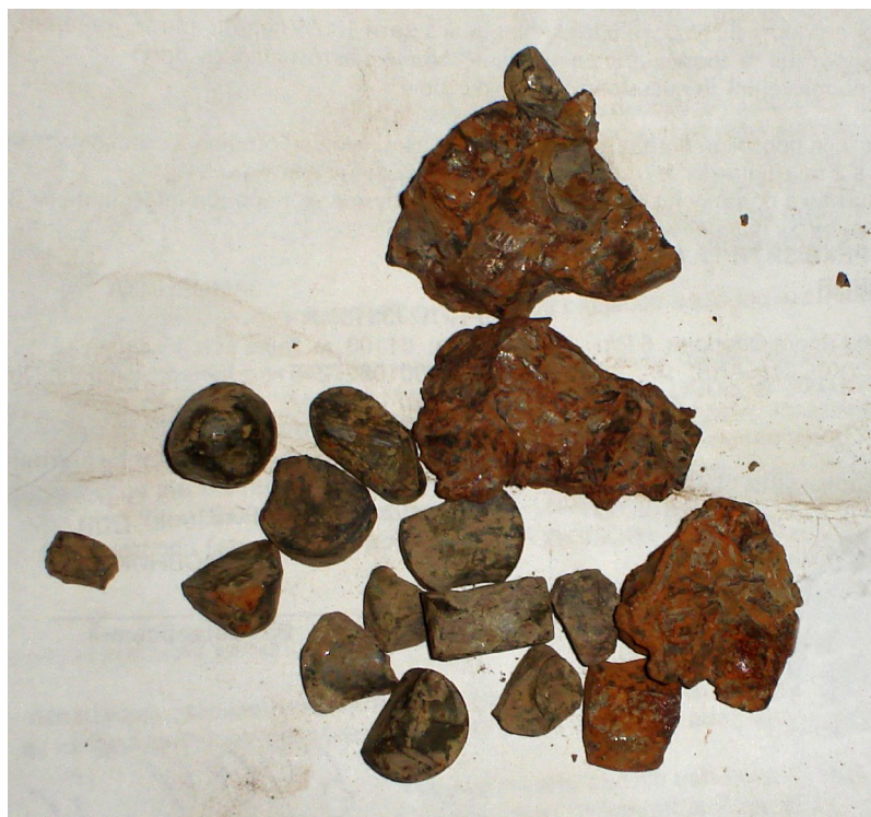
Рис. 5. общий вид крупного шлама из МУК-214.
