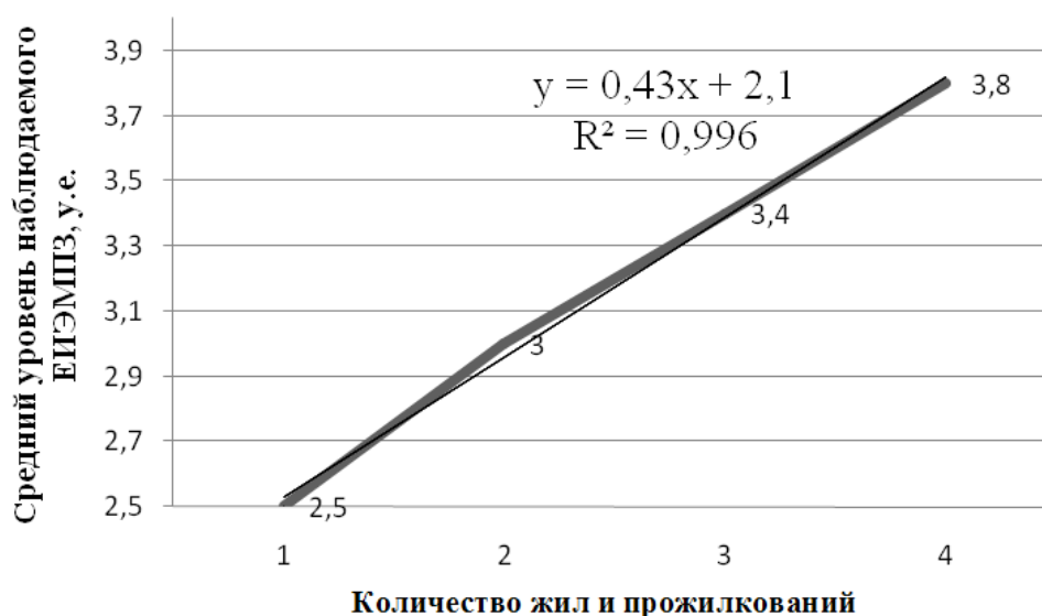
Рисунок 8 - График связи на качественном уровне распределения количества жильных зон и зон прожилкования с уровнем наблюдаемого ЕИЭМПЗ (у.е.) y = 0,43x + 2,1 ; R^2 = 0,996 , где x – уровень поля ЕИЭМПЗ (у.е.), y – осредненное значение содержания золота (г/т), R^2 – коэффициент корреляции
