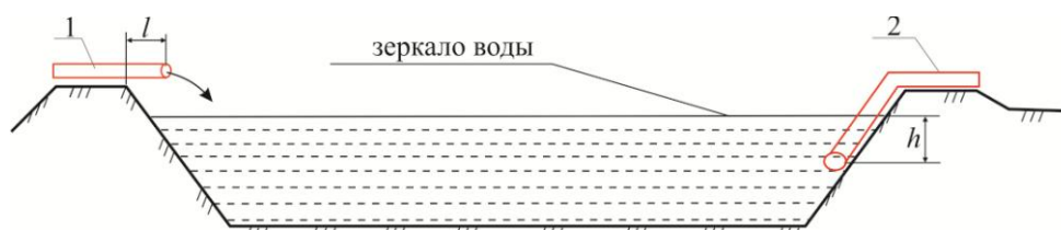
1 – наземный выпуск, 2 – заглубленный выпуск; h - глубина погружения выпускного патрубка; l - дальность выпуска от дамбы
