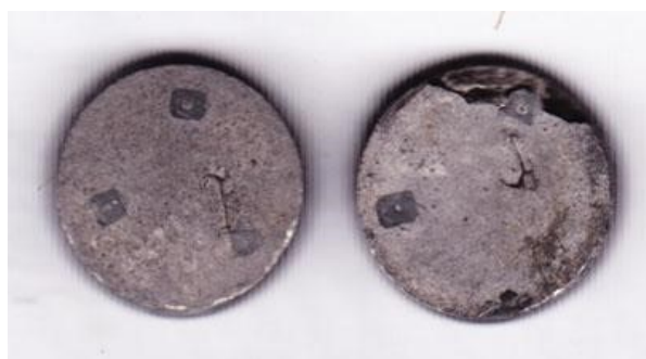
Рис. 3. Загальний вигляд ростових шарів після вирощування та розбирання комірки
