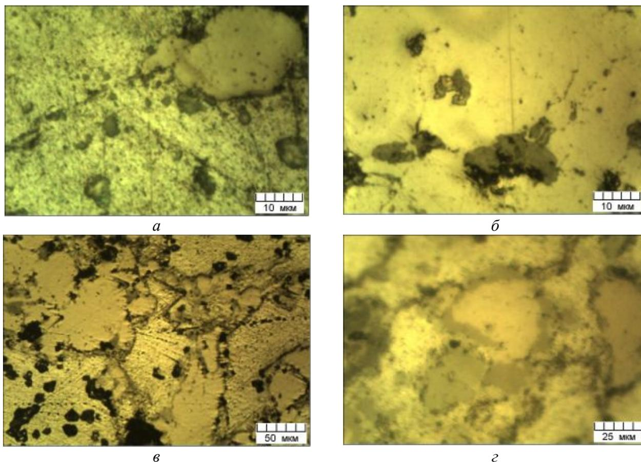
Рис. 2. Микроструктура компактов из гранул Ni – 10 мас. % Al: а – давление 5 ГПа, температура 775 К, длительность спекания 5 мин; б – давление 5 ГПа, температура 1075 К, длительность спекания 5 мин; в – давление 3 ГПа, температура 1275 К, длительность спекания 5 мин; г – давление 5 ГПа, температура 1775 К, длительность спекания 3 мин
