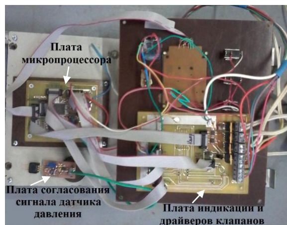
Рис. 4. Основные платы системы управления ГГС
