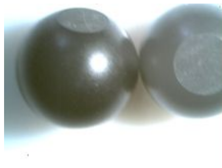
Рис. 6. Загальний вигляд алмазного композиційного матеріалу у формі кулі
