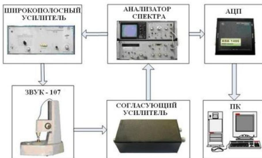
Рис. 1. Схема системы контроля демпфирующих свойств
