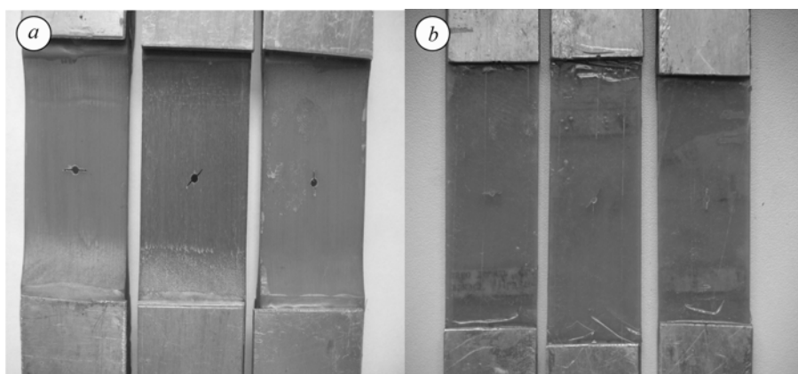
Рис. 1. Загальний вигляд зразків зі склопластиків ЕФ 32-301 (а) і 27-63С (b).
