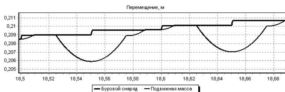
Рис. 1. Пример моделирования перемещения бурового снаряда ПБС-М и утяжелителя при бурении
