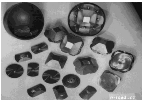
Рис. 11. Аппарат типа разрезной сферы в разобранном виде
