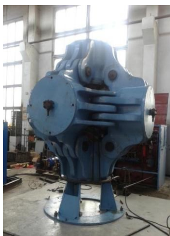
Рис. 8. Китайский вариант кубического АД с гидроцилиндрами силой по 25 МН
