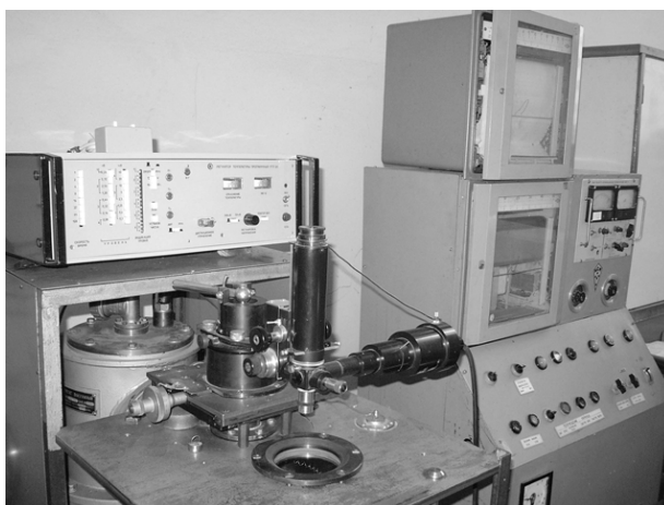
Рис. 1. Установка для измерения микротвердости алмазов и других сверхтвердых материалов при высоких температурах.
