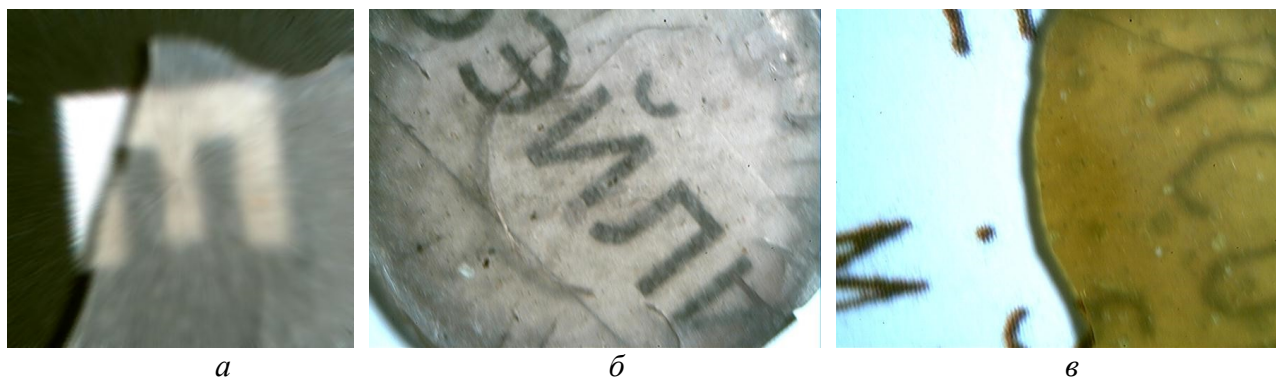
Рис. 5. Степень прозрачности образцов оптической керамики из YAG с активирующими добавками: а – 3% (по массе) Nd_2O_3 ; б – 5% (по массе) Nd_2O_3 ; в – 2% (по массе) CeO (параметры спекания: p = 7,5 ГПа; T = 500 °С; \tau = 2,5 хв.)
