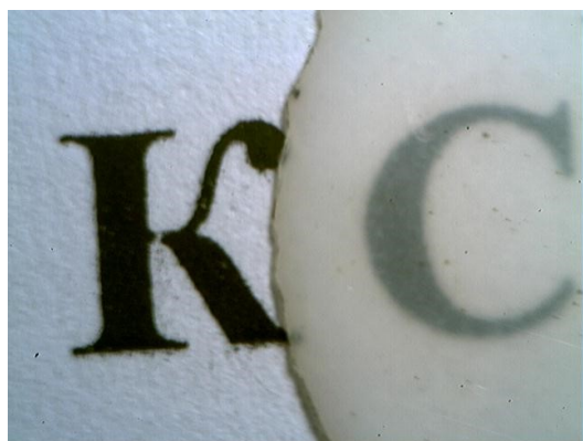
Рис. 3. Керамика из нанопорошка YAG, полученная при 450 °С [4]
