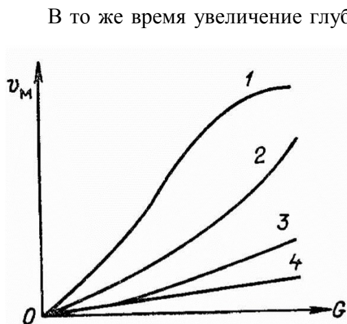
Рис. 1. Зависимость скорости бурения от осевой нагрузки для различных пород: 1 – мягкие; 2 – средней твердости; 3 – твердые; 4 – крепкие породы
