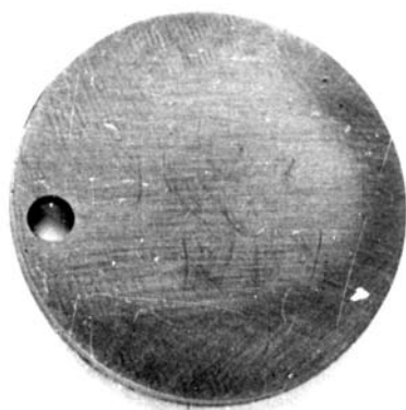
Рис. 2. Загальний вигляд зразка сталі 20 після 24 days експозиції в гної великої рогатої худоби.
