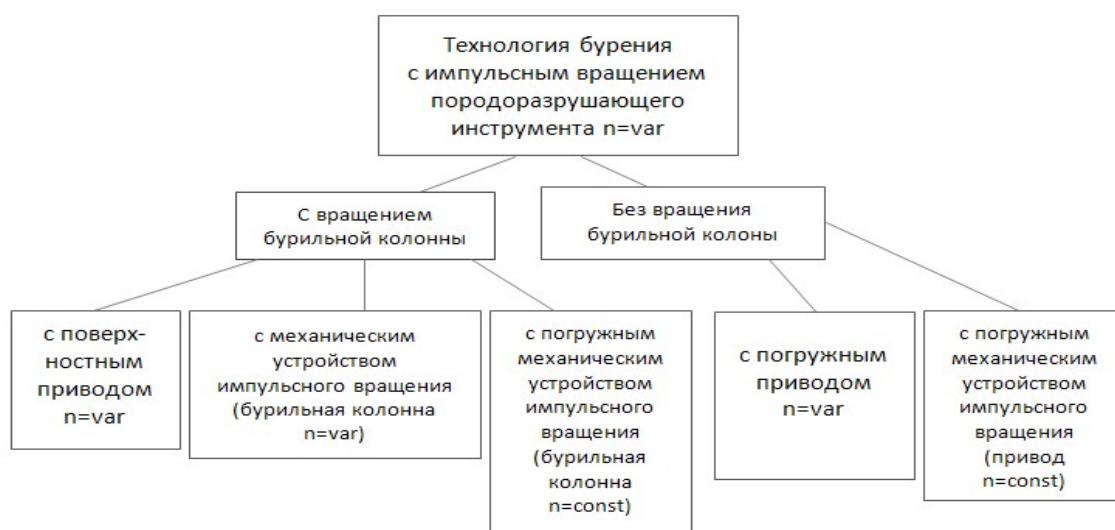
Рис. 2. Классификация технологий бурения с импульсным вращением породоразрушающего инструмента
