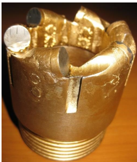
Рис. 1. Общий вид буровой коронки типа БП-24, оснащенной гибридными АТП
