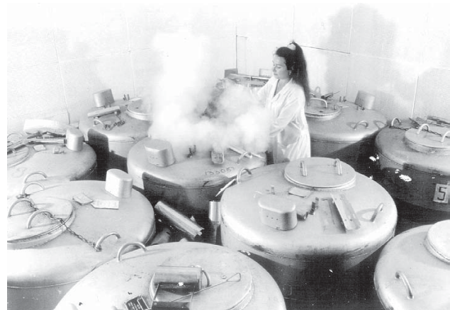
Рис. 2. Низкотемпературный банк института проблем криобиологии и криомедицины НАН Украины (хранилища ХБ-0,5 производства завода кислородного машиностроения, г.Екатеринбург, Россия).
