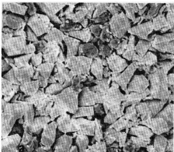
Рис. 1. Частицы WC–Co, светлое – TiC, тёмное – Co, \times 1000 [2]
