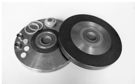
Рис. 1. Вид блок-матриц аппарата высокого давления ВС-021а
