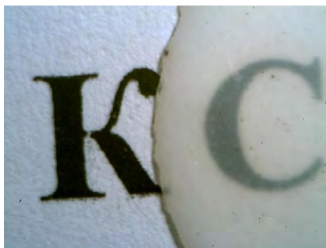
Рис. 3. Керамика из нанопорошка Y_3Al_5O_{12} , полученной при 450 °С
