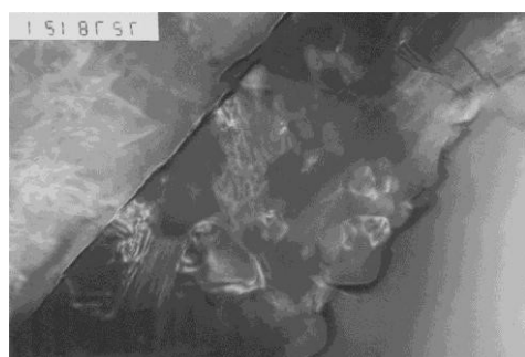
Рис. 4. Типичный участок микроструктуры образца с трещинами по границам сопряжения алмаз – алмазоподобная фаза (стрелкой указаны области разрыва по границам с отдельными зернами алмазоподобной фазы)
