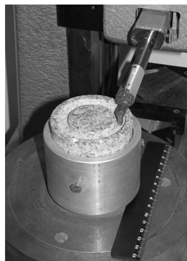
Рис. 2. Общий вид процесса измерения параметров шероховатости микропрофиля поверхности забоя
