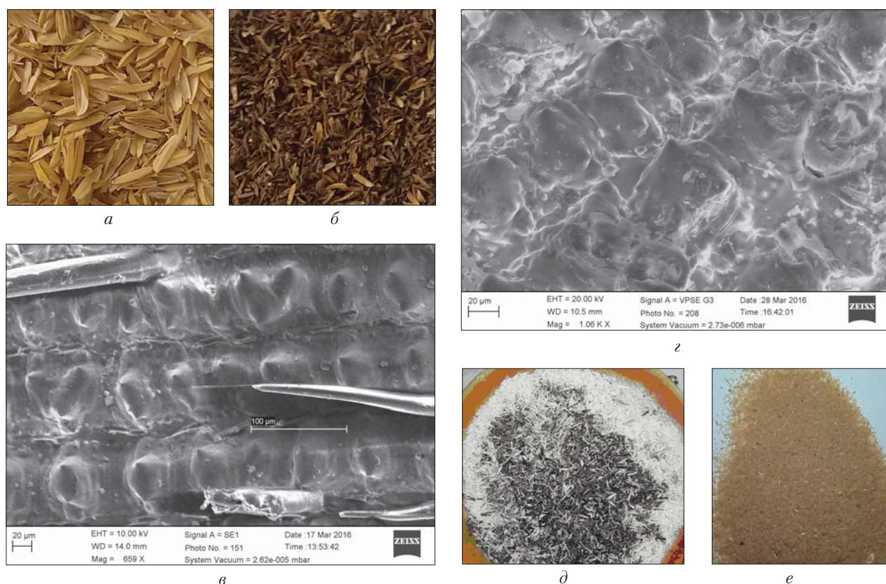
Рис. 5. Макро- (а, б, д, е) та мікрофотографії (в, з) вихідної (а, в) та обробленої вибуховим автогідролізом (б, з) рисової лузги та її зольного залишку (д, е) до (д) та після (е) термобаричної обробки
