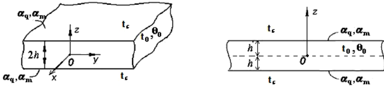
Рис. 1. Схема перерізу пластини, що конвективно висушується теплим повітрям
