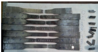
Рис. 2. Фото зразків після випробувань на розривній машині та установці визначення ударної в'язкості
