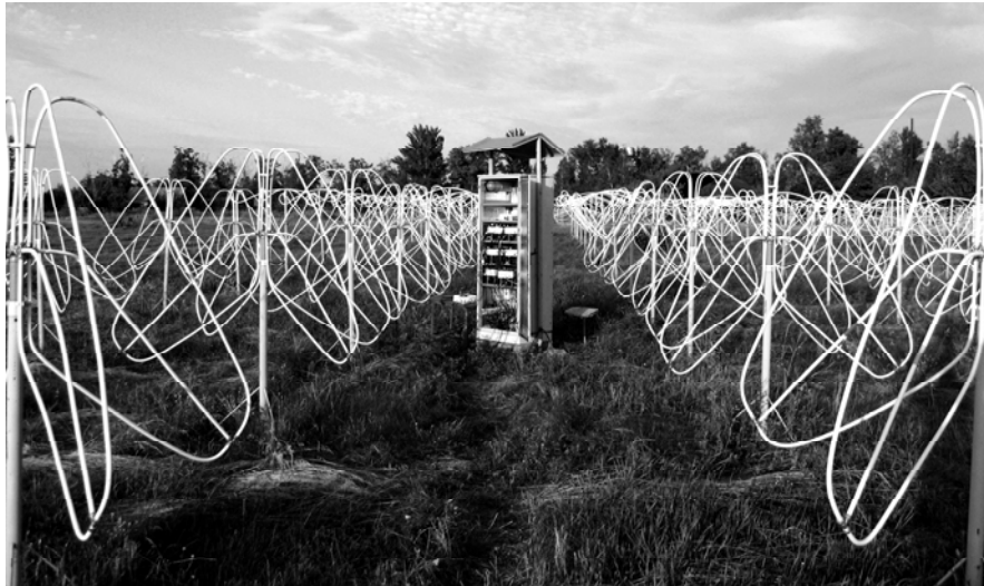
Рис. 19. Субрешетки сверхширокополосного РТ нового поколения ГУРТ
